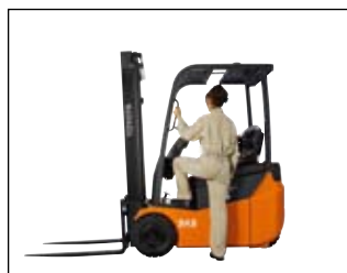
Malá nástupní výška Unadňuje přístup do vozíku bez ohledu na vzrůst řidiče.
